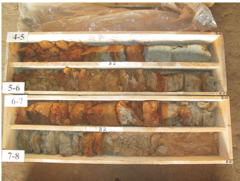
Bild 6: Kernbohrung 2, 4,0 bis 8,0 m.
