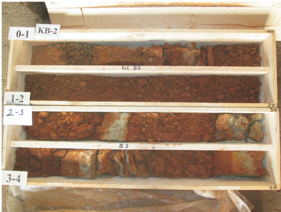
Bild 5: Kernbohrung 2, 0,0 bis 4,0 m.
