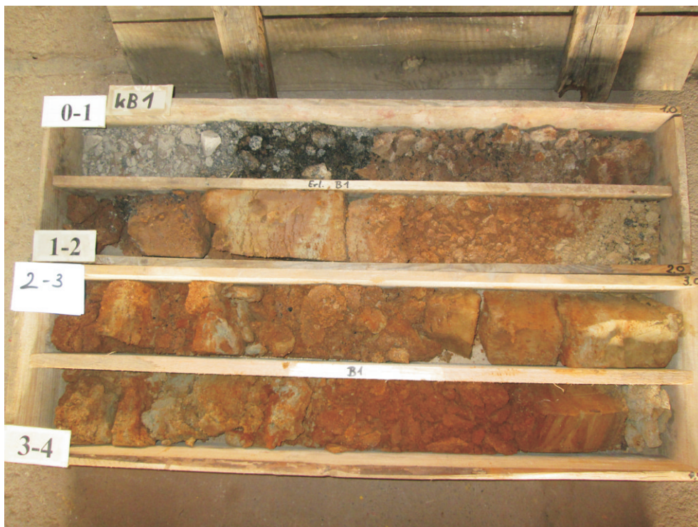
Bild 1: Kernbohrung 1, 0,0 bis 4,0 m.
